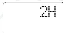
При задании задержки пуска на дисплее отображается обратный отсчет времени (последовательно по часам, затем 90 и поминутно начиная с 60 минут).
