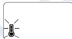
В процессе выполнения цикла происходит изменение символа при нагревании прибора.
