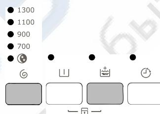
Нажмайте в течение нескольких секунд кнопки “Отжим” ⏳ и “Полоскание плюс” ⌂. Функция окажется включенной постоянно, даже при отключении прибора от электросети.
